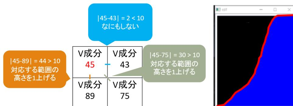
図 1 Contrast Pair 法によるトーンカーブ作成
